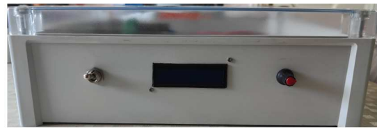
(b) Voorzijde: LCD display, schakelaar en potentiometer om de frequentie in te stellen
